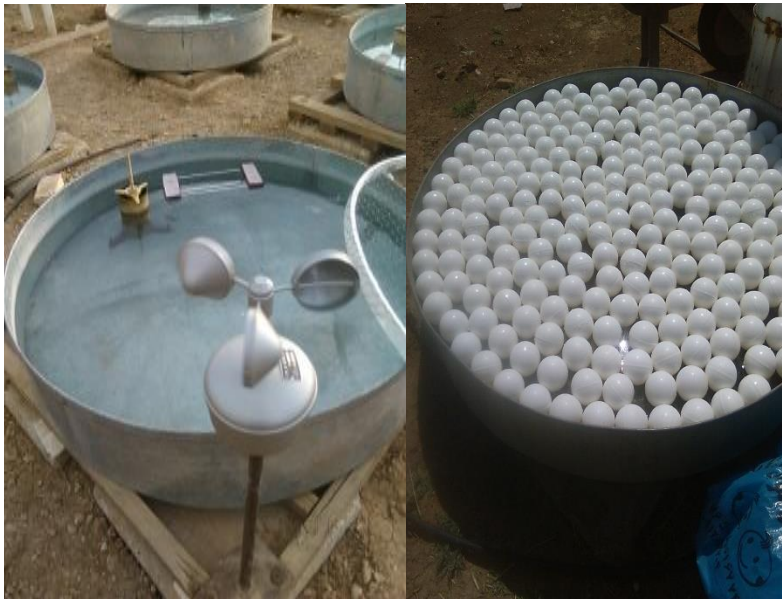
شکل (۲) - سمت چپ تشتک کلاس A شاهد، تصویر دوم تشتک دارای توپ بدون روزنه
